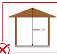
Les niveaux du terrain naturel et du terrain fini n'apparaissent pas, n'est pas représenté de limite à limite, pas d'indication d'échelle.
